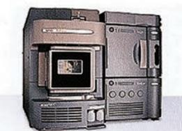
液体クロマトグラフタンデム四重極型質量分析計 (LC-MS/MS)
